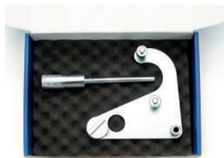
Blokada rozrządu 2,0 dCi Renault
